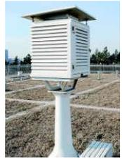
(1) 百叶箱的表面涂成白色，是为了①（选填“反射”或“吸收”）太阳光，避免阳光照射时，太阳光中的②（选填“红外线”或“紫外线”）对箱内温度的影响，并且要求安装百叶箱时其门朝向③（选填“北”或“西”）。
